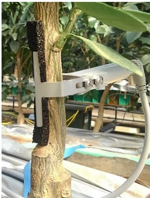
図1. デンドロメータの設置状況 MIJ-0.2LMS TypeII 日本環境計測株式会社製
